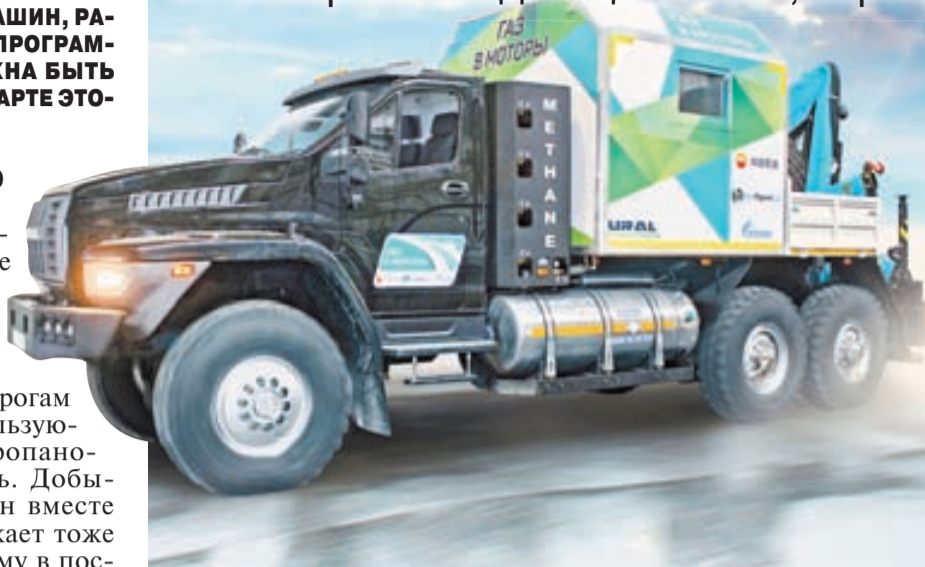
Новый грузовой автомобиль «Урал Некст LNG», работающий на природном газе, может пройти на одной заправке 1000 км, расходуя 26 кг газа на 100 км. Экономия по сравнению с дизельными двигателями — 130 тыс. руб. на 10 тыс. км.
