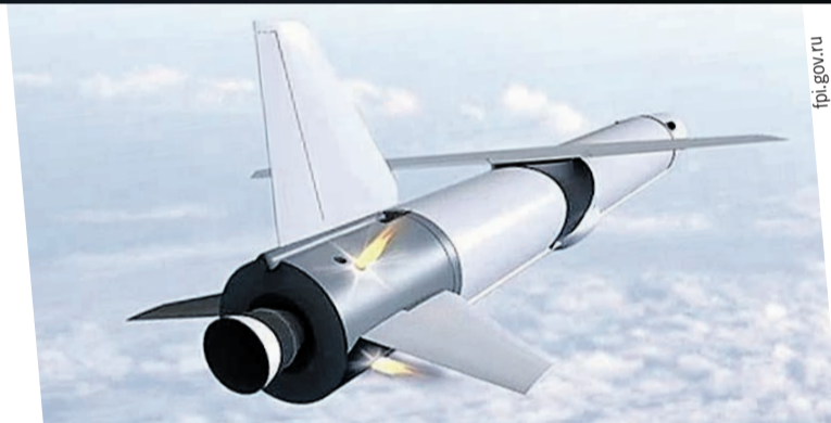
Многоразовая ракета «Крыло-СВ», по плану, должна приземляться не вертикально, а как самолет.
