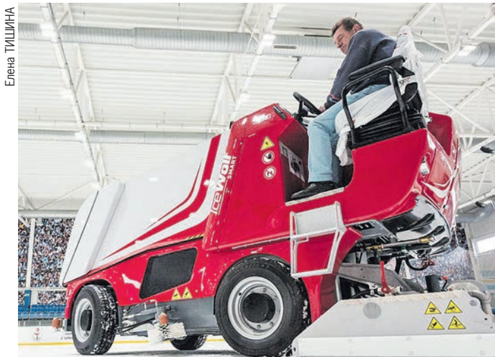
Новая ледозаливочная машина на электрическом двигателе заряжается за ночь.
