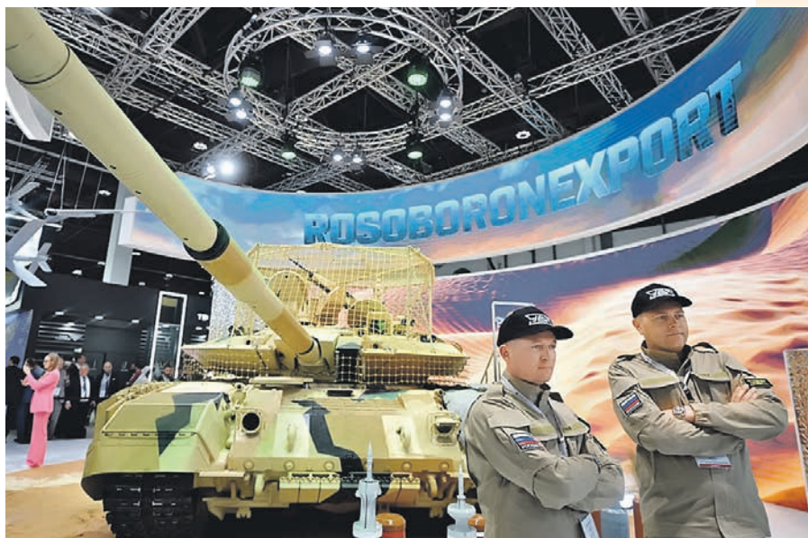
Танк «Прорыв» теперь с модным «мангалом» - решеткой над башней - защитой от дронов.
