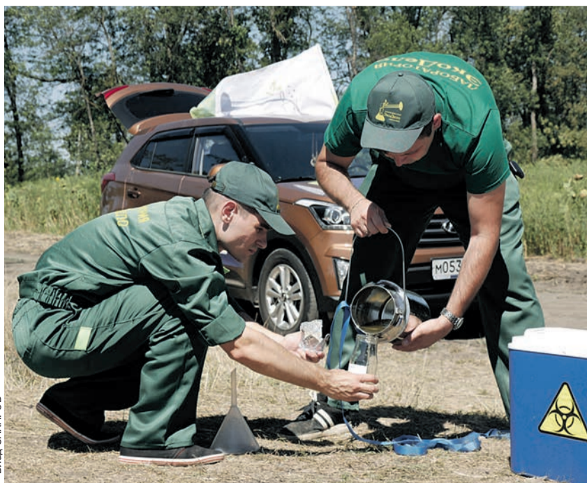
Для отбора проб воды специалисты лаборатории «ЭкоДело» использовали химический батометр.
