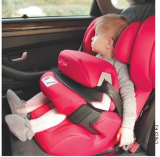
безопасности, стягивающий лямки штатного автомобильного ремня (детям, отменим, не-обходимы специальные устройства именно потому, что штатный ремень безопасности автомобиля не подходит им по размеру). Пристегнутый с таким адаптером ребенок теоретически не рискует повредить шею при столкновении.
