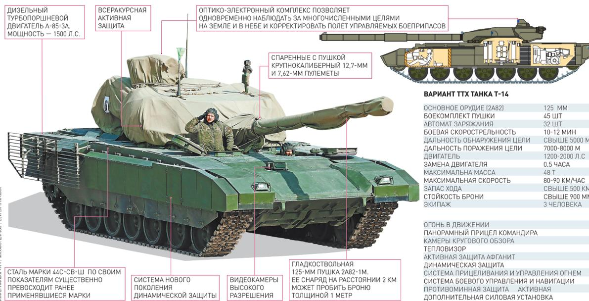
ДИЗЕЛЬНЫЙ ТУРБОПОРШНЕВОЙ ДВИГАТЕЛЬ А-85-3А. МОЩНОСТЬ — 1500 Л.С.
