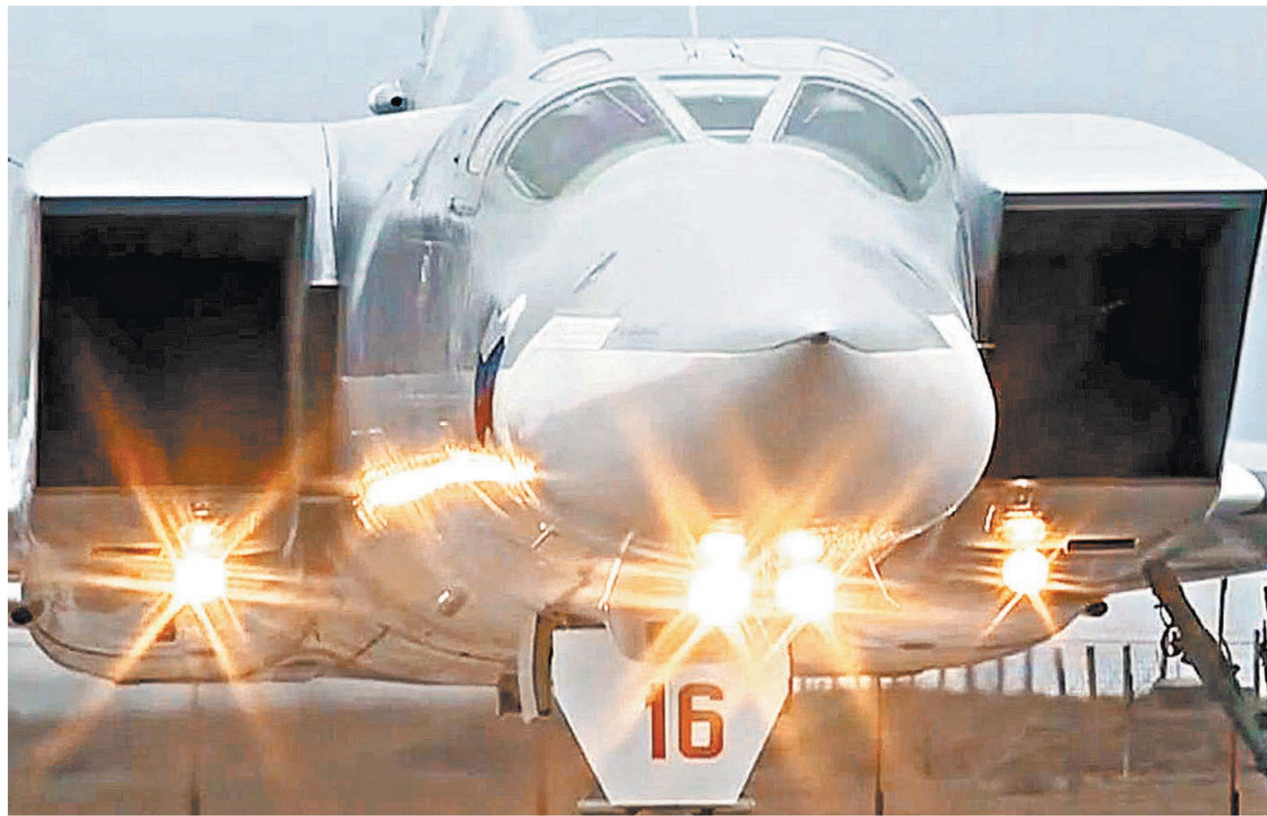
Сверхзвуковой бомбардировщик дальней авиации Воздушно-космических сил России Ту-22М3 способен нести до 24 тонн бомб и при этом развивать скорость до 2300 километров в час.
