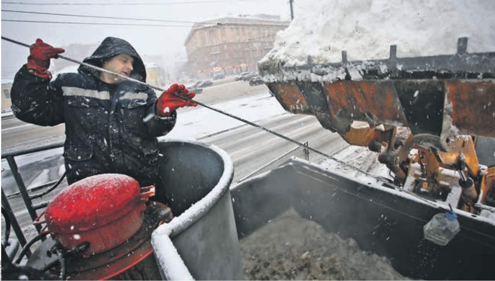
Вчера 10:47 Кудринская площадь. За работой начальник мобильного снегоплавильного пункта Юрий Насонов. Весь цикл работы машины составляет 4–5 часов. За это время установка прогревается, в плавильный котел загружаются тонны снега. Затем машина нуждается в обязательной очистке от грязи
