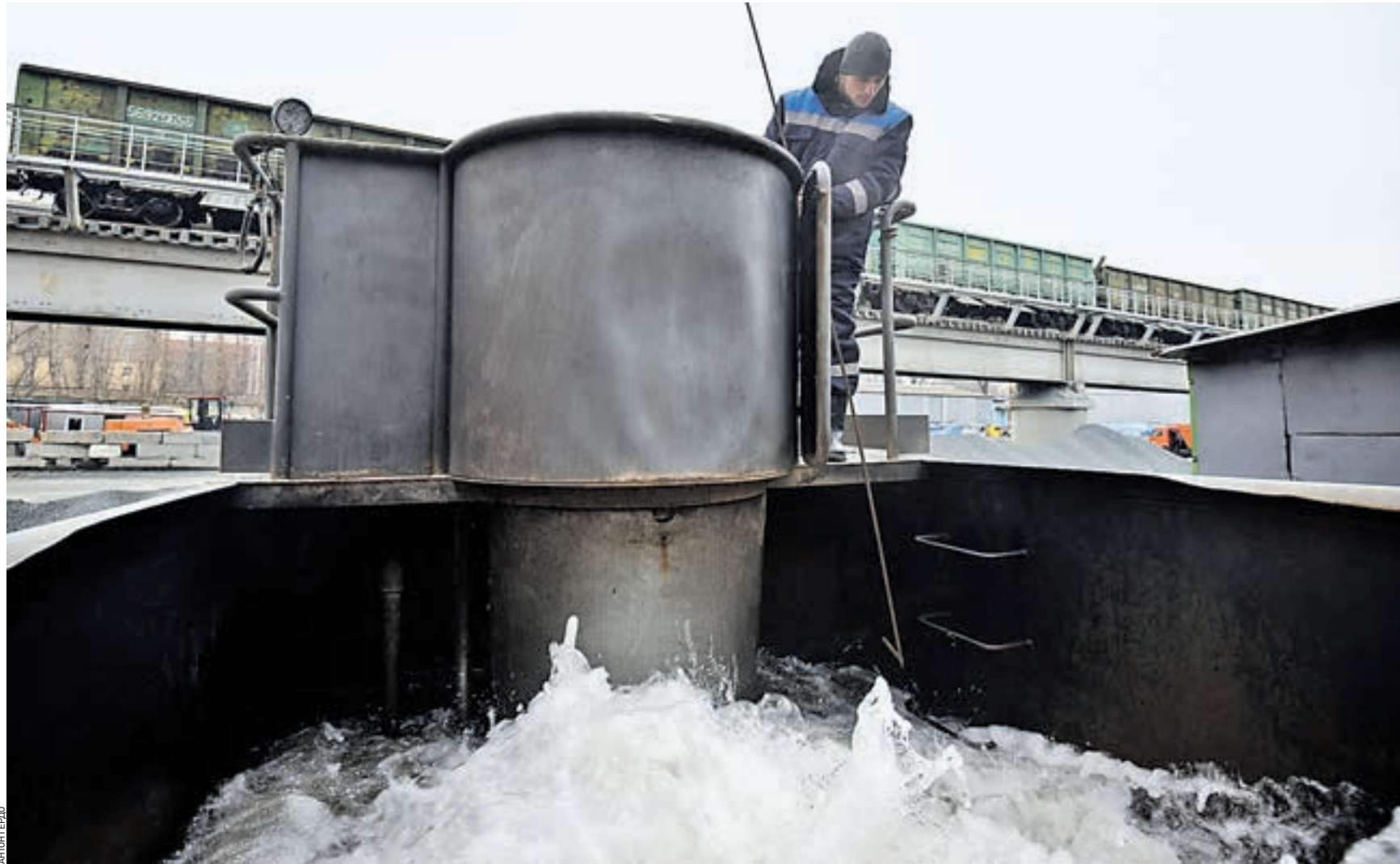
Вчера 13:50 Оператор ГБУ «Автомобильные дороги» Сергей Ушаков проверяет, как работает мобильная снегоплавильная установка. Вода уже нагрелась до нужной температуры: 50–70 градусов. Теперь можно забрасывать и плавить снег. Осталось только его дожидаться
