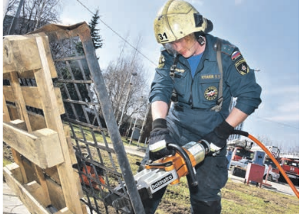
Вчера 10:30 Прапорщик Антон Кулаков показывает, как с помощью спецтехники разрезать толстые железные прутья решетки
