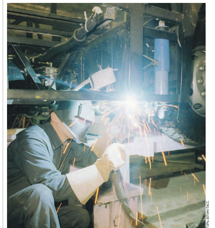
1 декабря 1997 года. Сварка кузова автобуса на Тушинском машиностроительном заводе
