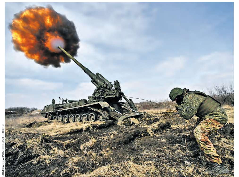
27 марта. Самодвижущаяся артиллерийская установка (САУ) «Малка» артиллерийских подразделений Центрального военного округа (ЦВО) во время боевой работы на авдеевском направлении специальной военной операции. Главное оружие САУ «Малка» — семиметровая нарезная пушка 2А44 калибра 203 миллиметра с поршневым затвором. Она способна совершать 50 выстрелов в час. Комплекс 2С7М посылает снаряды на расстояние до 47,5 километра.
