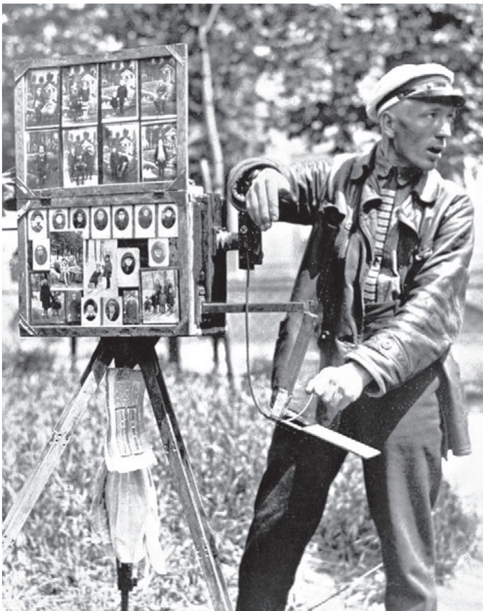
1920-е годы, Россия. «Холодный фотограф» за работой: делает фото при помощи затвора фирмы «Торнтон-Пикар» на тросике, прикрывая затвор рукой от солнца
