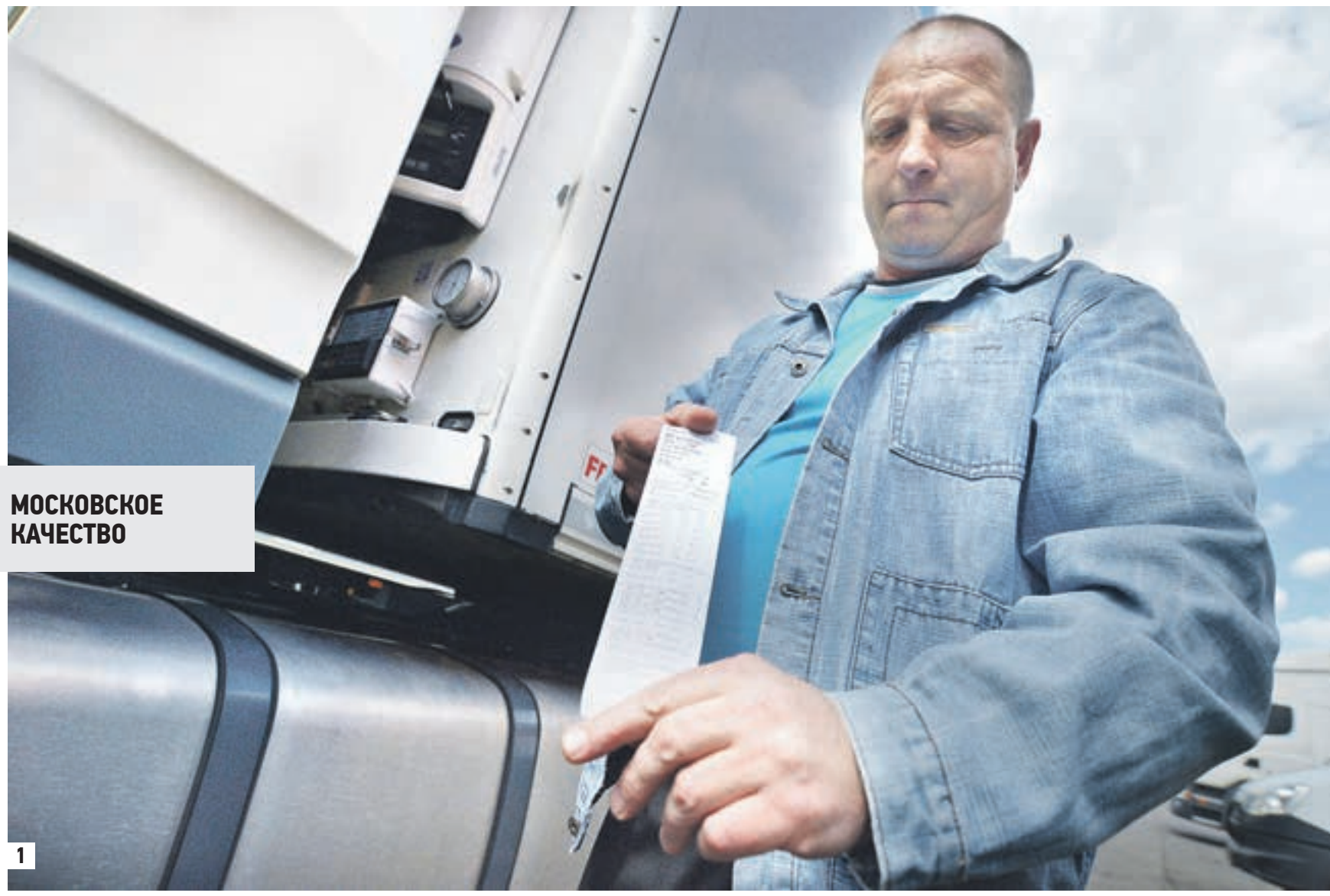
10 июня 17:57 Водитель грузовика Сергей Репкин показывает отчет о температуре внутри фургона. Показания автоматически снимаются каждые 15 минут.
