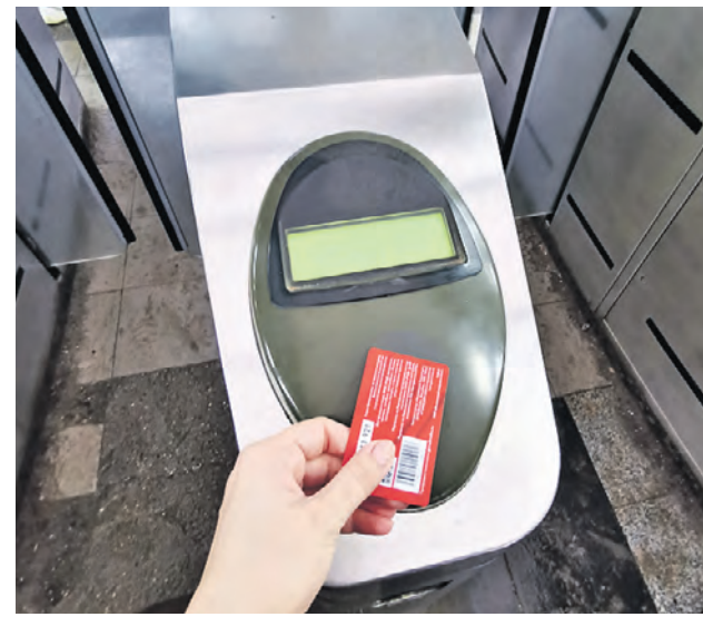
На станциях МЦД установлены турникеты или валидаторы — на выходе к ним нужно приложить карту
